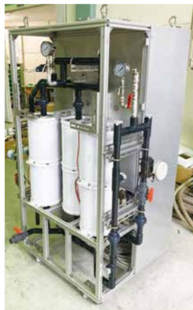
CDIを搭載した新たな浄水装置「ゼオスター」。コンパクトでありながら井水浄水処理から排水処理まで広範囲に対応する
